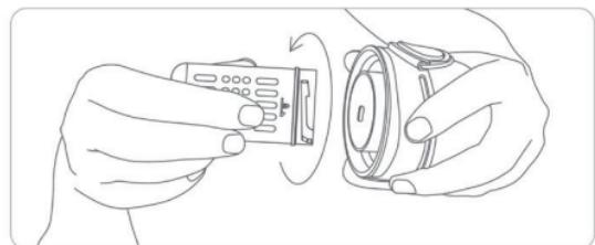
Halten Sie den Flaschendeckel so, dass das Filterelement auf dem Flaschen-deckel leicht nach oben zeigt. So verhindern Sie, dass der Aktivkohlefilter nach der Demontage herunterfällt. Drehen Sie nun das Filterelement gegen den Uhrzeigersinn, um es aus dem Deckel heraus zu drehen und zu ent-fernen.
