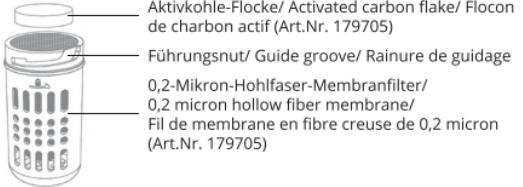
Dieses Produkt kann 99,9999 % der Bakterien und 99,9 % der Protozoen (Giardia, Cryptosporidium usw.) im Wasser filtern, reduziert die Trübung und absorbiert Restchlor, um den Geschmack des Wassers zu verbessern.
