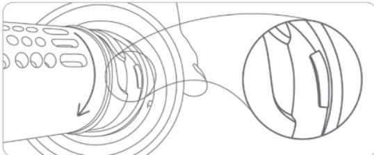
Achten Sie beim Einsetzen des Filterelementes auf die richtige Lage der Führungsnuhen und drehen Sie das Filterelement im Uhrzeigersinn fest.
